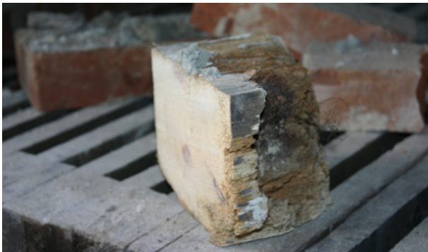
Den bit trä som visas på de två bilderna utgjorde en stolpe som återfanns i murverket. Tegelstenar ersatte trästolpen.
