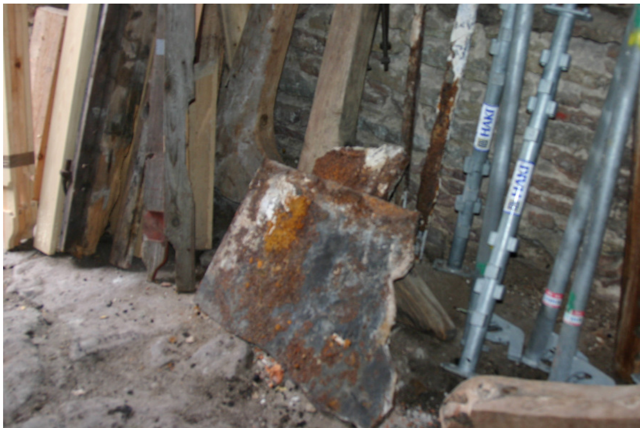
Två gjutjärnsplåtar innanför sotluckan - en i "tak" och en på "golvet" - byttes ut. En gammal plåt ses på bilden ovan och en av de nya ses nedan. Lyrestads Gjuteri AB, göt de omkring 0,6 x 0,8 m stora plåtarna. Foto nedan av Erik Bergholtz.
