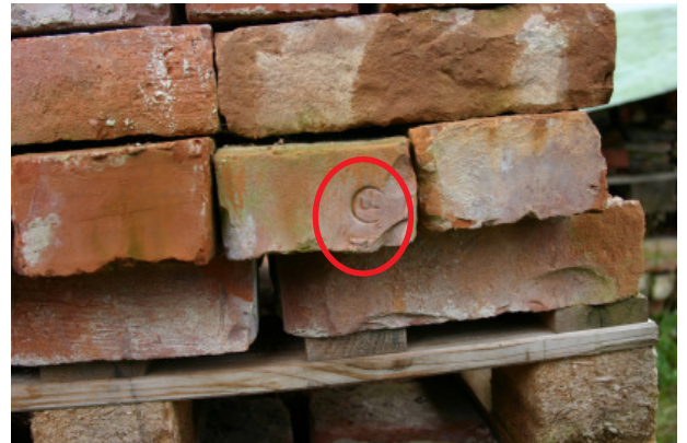
Det tegel som använts till årets murarbete kommer från en numera rivna byggnad på Nygården. Vilket tegelbruk som en gång producerat stenarna är osäkert men det kan vara Frugården på Vänäsån eller Sätenäs tegelbruk som levererat annat tegel till den numera rivna byggnaden 1894 när det byggdes. En del av stenarna var märkta med ett F i en cirkel, (F). (Ovan markerat med en röd ring.)
