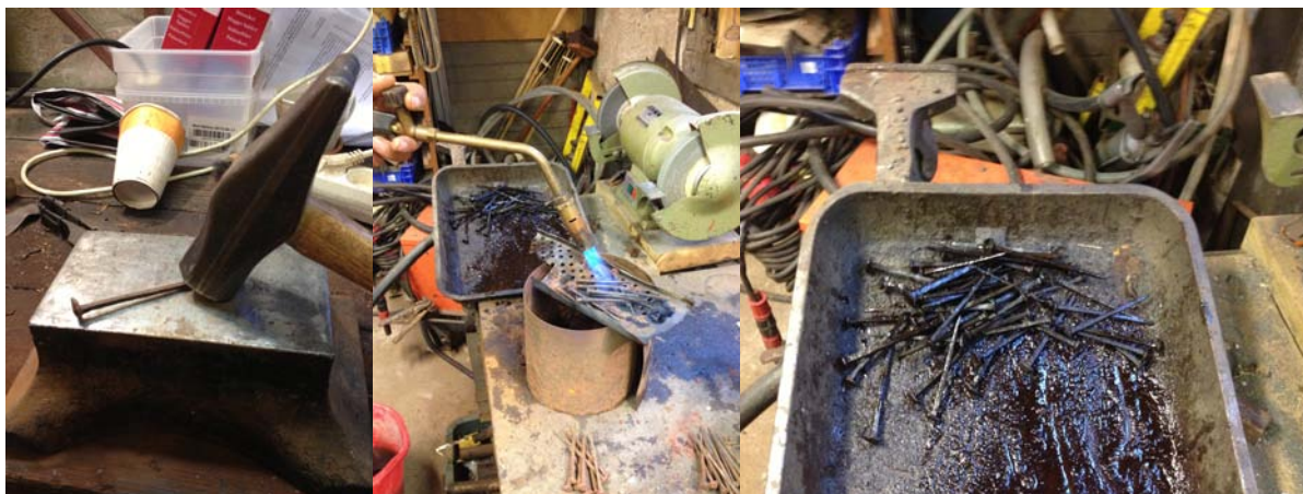
Alla spik återvinns, de riktas, bränns med gasol och doppas i linolja efter bränning för att återfå struktur och bli motståndskraftiga.
