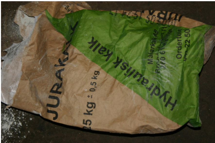
Hydraulisk kalkbruk används till reparationerna av sockeln. Men även luftkalk kommer att användas.
