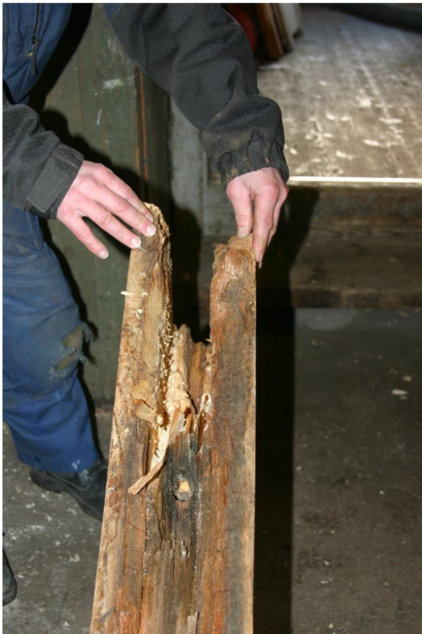
På plats såg rotnät friskt ut men vid närmare undersök- ning visade det sig att det var rötskadat på insidan. Foto: Lena Bergman
