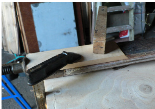
En del av ett sidostycke där nytt trä ska skarvas i, halvsulning. Nedan: Halvsulningen har limmat fast med kaseinlim och kommer bearbetas till rätt form. De fyra småbilderna - Foto Erik Bergholtz.
